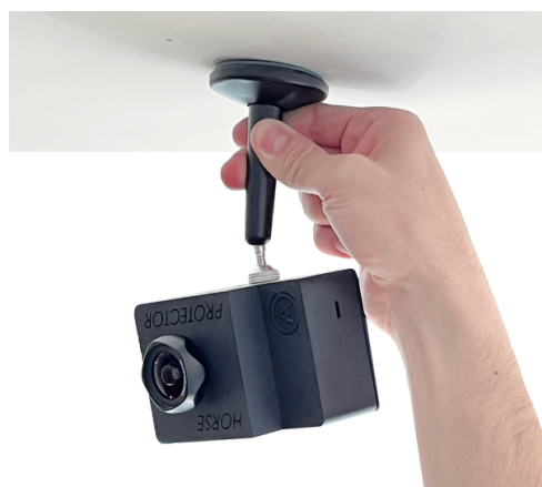
Montage an der Decke
